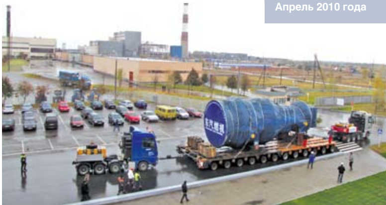
Доставка на Минскую ТЭЦ-5 парогазовой турбины для нового энергоблока. Апрель 2010 года
