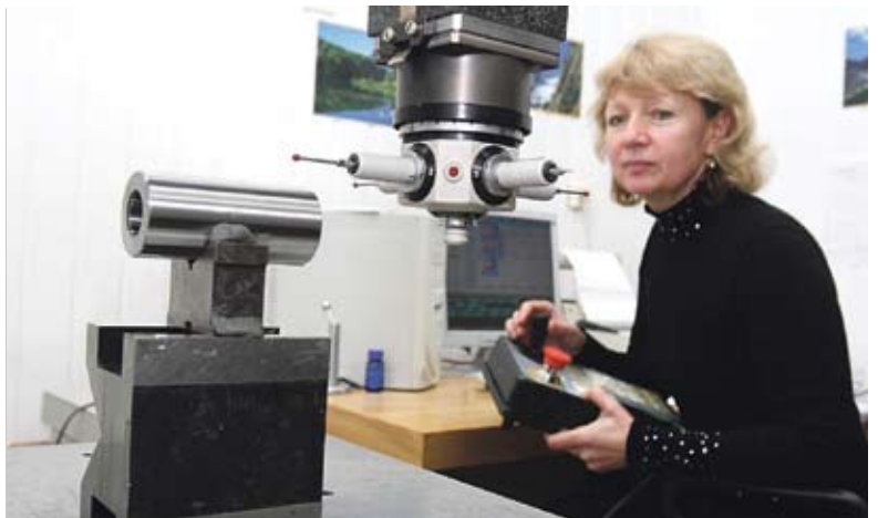
Контроль качества деталей на трехкоординатной измерительной машине
