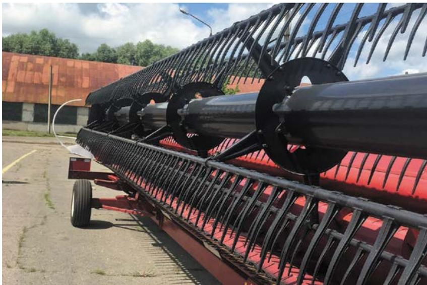
В серийной девятиметровой жатке 395 полимерных зубьев
