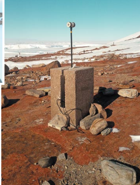
Геокриолог Андрей Мурашко обустроил три стационарные площадки для мониторинга температурного режима в толще горных пород и приповерхностном слое атмосферы
