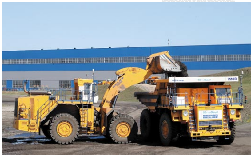
▲ Роботизированный комплекс «погрузчик – карьерный самосвал» в действии на испытательном полигоне БелАЗа. 2019 год
