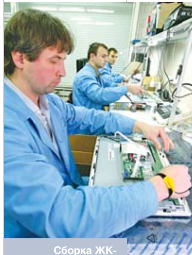
Сборка ЖК-мониторов на УП «Интеграл-техник» – дочернем предприятии НПО «Интеграл»
