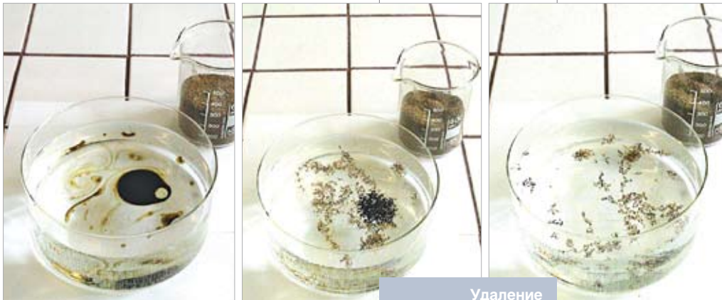
Удаление нефтяного загрязнения с поверхности воды торфяным сорбентом
