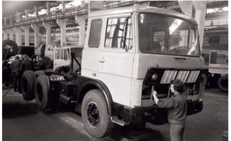
▲ Сборка МАЗ-6422 в экспериментальном цехе. 1981 год
