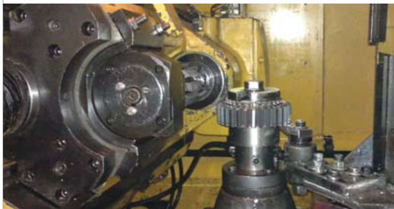
Процесс изготовления зубчатых колес из новой стали на МТЗ
