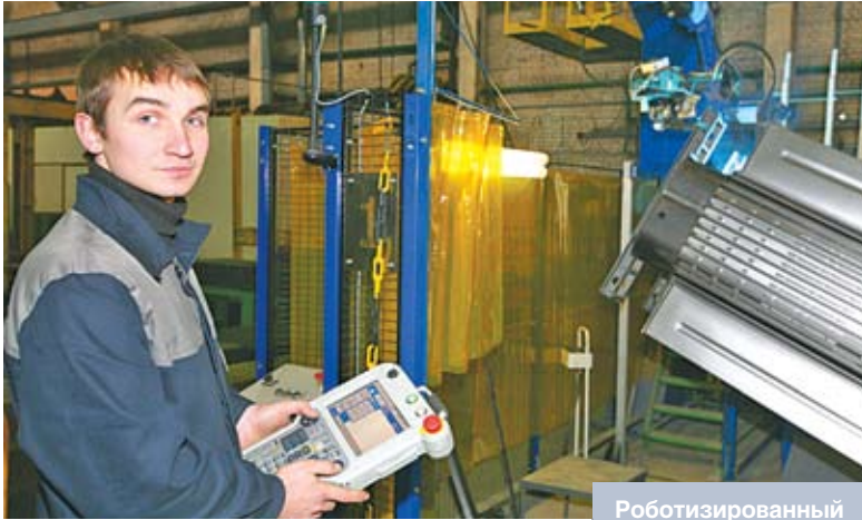
Роботизированный комплекс для сварки трансформаторов большой мощности на Минском электротехническом заводе имени Козлова
