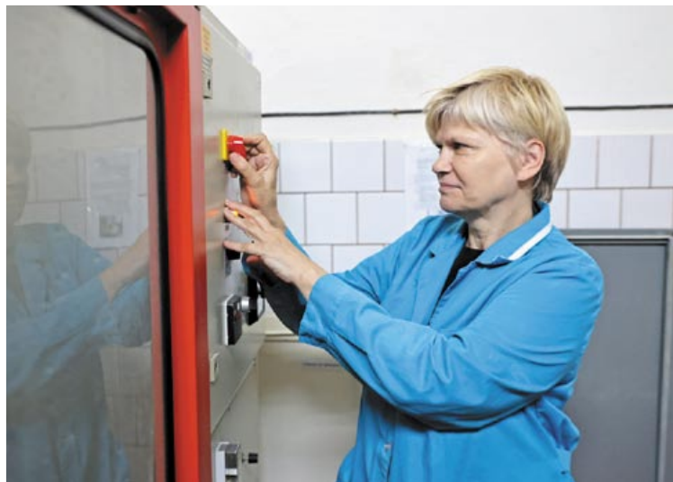
Инженер по испытаниям Галина Дрובה: светотехника должна быть устойчивой к перепадам температур, вибрации, пыли и соляному туману
