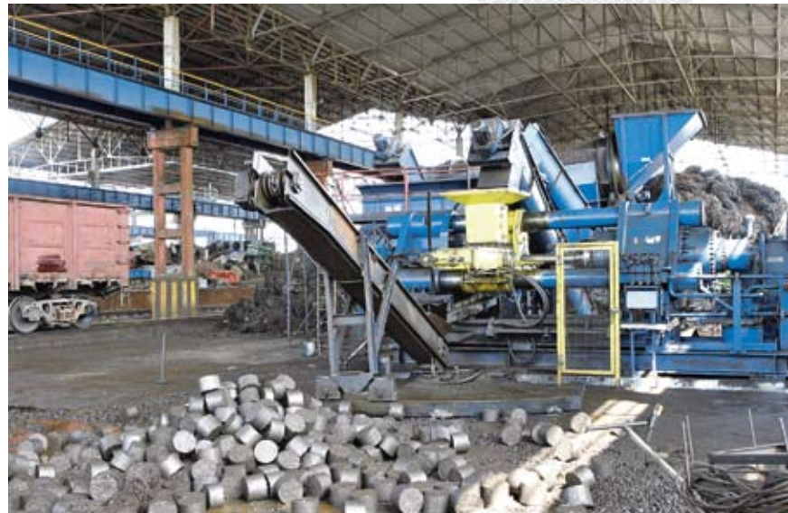
▲ Линия по брикетированию стружки
