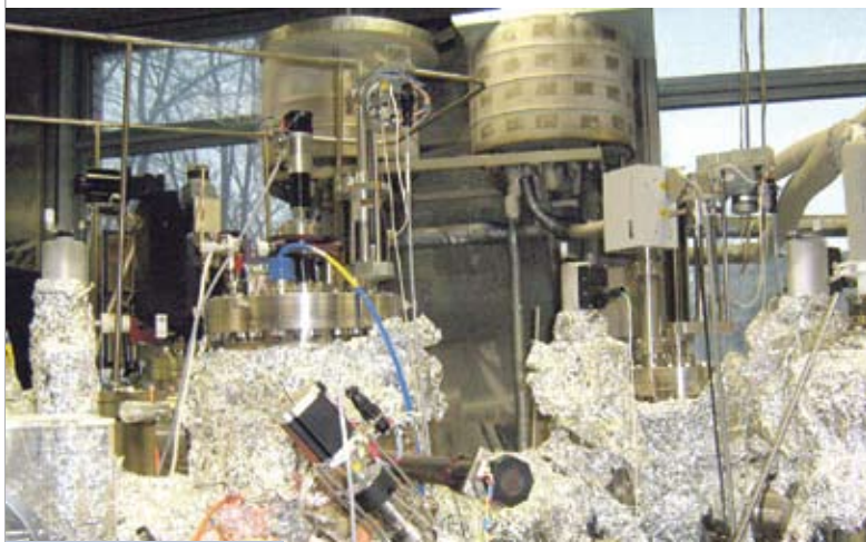
Установка молекулярно-пучковой эпитаксии в Физико-техническом институте имени А.Ф. Иоффе (Санкт-Петербург)
