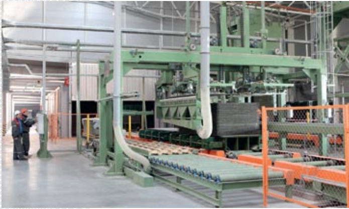
▲ У цэxu на выпуску цэментна-стружкавых пліт ЗАТ «Белзарубеж- буд» у Крычаве
