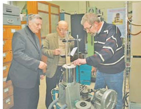
Сотрудники Института тепло- и массообмена НАН Беларуси В.А. Бородуля, Л.М. Виноградов и А.Ж. Гребеньков проводят модельные исследования на установке с кипящим слоем
