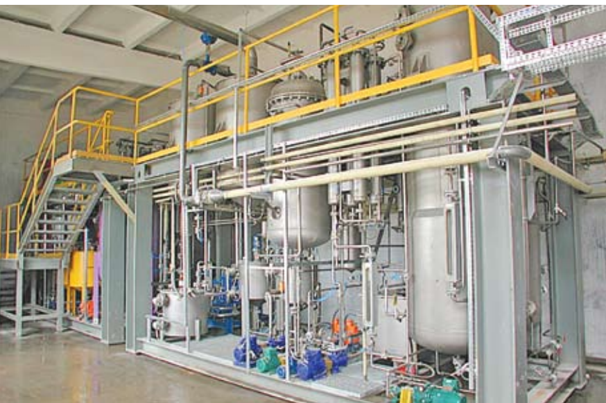
Опытно-промышленная установка для получения биотоплива производительностью 5000 т в год (ОАО «Гродно Азот»)
