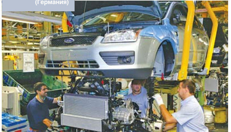
Сборка автомобилей Ford на заводе в Саарлуисе (Германия)
