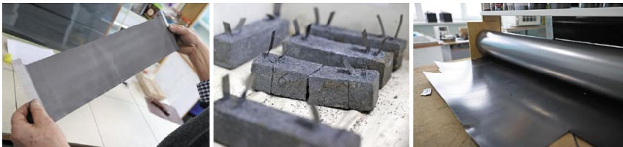
Усиленные графеном: гибкие нагревательные элементы, бетон, лист для полимерной трубы
